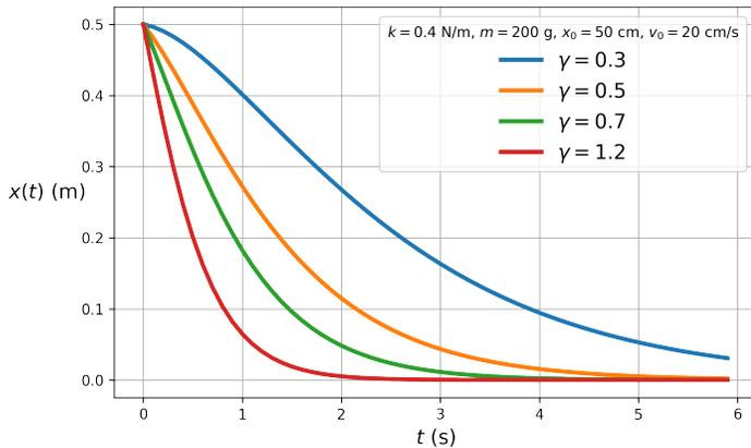
**Fig. 3:** Un oscilador críticamente amortiguado con  $k = 0.4 \text{ N/m}$ ,  $m = 200 \text{ g}$ ,  $x_0 = 50 \text{ cm}$ ,  $v_0 = 20 \text{ cm/s}$ , y  $\gamma = (0.3, 0.5, 0.7, 1.2) \text{ kg/s}$ .
