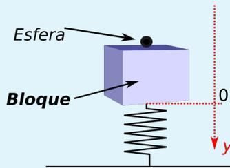
Un bloque unido a un resorte oscila verticalmente con una frecuencia de 4 Hz y una amplitud de 7 cm. Se coloca una pequeña esfera en la parte superior del bloque oscilante justo cuando alcanza su punto más bajo. Suponga que la masa de la esfera es tan pequeña que su efecto sobre el movimiento del bloque es insignificante. ¿A qué distancia de la posición de equilibrio del bloque el cordón pierde contacto con el bloque?
