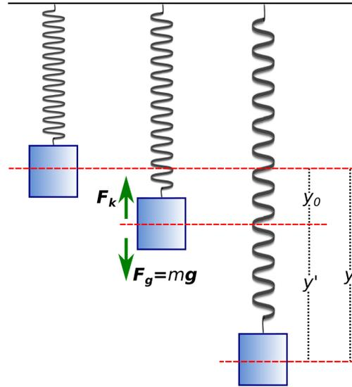
Fig. 4: Sistema masa-resorte oscilando en un plano vertical.
