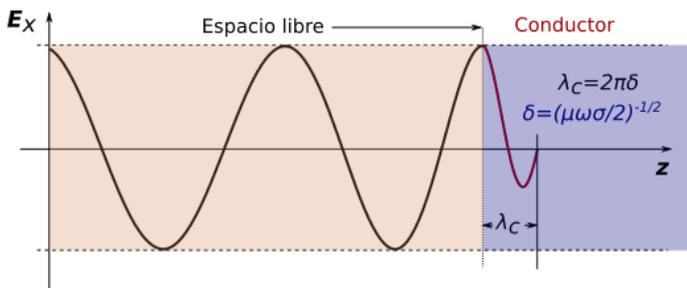
**Fig. 4:** Las ondas electromagnéticas en un dieléctrico golpean la superficie plana de un conductor, y el vector de campo eléctrico  $E_0$  se amortigua a un valor  $E_0 e^{-1}$  a una distancia de  $(2/\omega\mu\sigma)^{1/2}$ , conocido como *skin depth*. Esto explica las propiedades de blindaje eléctrico de un conductor.  $\lambda_c$  es la longitud de onda en el conductor.
