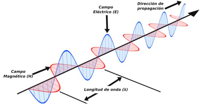
**Fig. 2:** En una onda electromagnética polarizada en plano, el vector de campo eléctrico  $E_x$  y el vector de campo magnético  $H_y$  son perpendiculares entre sí y varían sinusoidalmente. En un medio no conductor están en fase. El producto vectorial,  $E \times H$ , da la dirección del flujo de energía.
