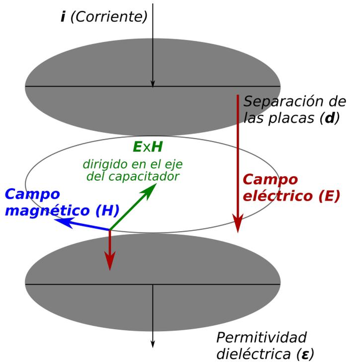
**Fig. 3:** Durante la carga, el vector  $E \times H$  se dirige al volumen del condensador. Al final de la carga, la energía es totalmente electrostática e igual al producto del volumen del condensador,  $Ad$ , y la energía electrostática por unidad de volumen,  $\epsilon E^2/2$ .
