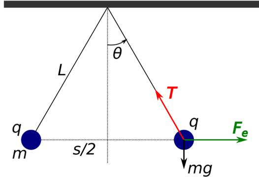
**Fig. 3:** Un electrómetro simple. Las dos esferas son de igual masa  $m$  y igual carga  $q$ . Al medir la separación con el ángulo  $\theta$  (que están relacionados), se puede determinar la fuerza eléctrica y la carga.
