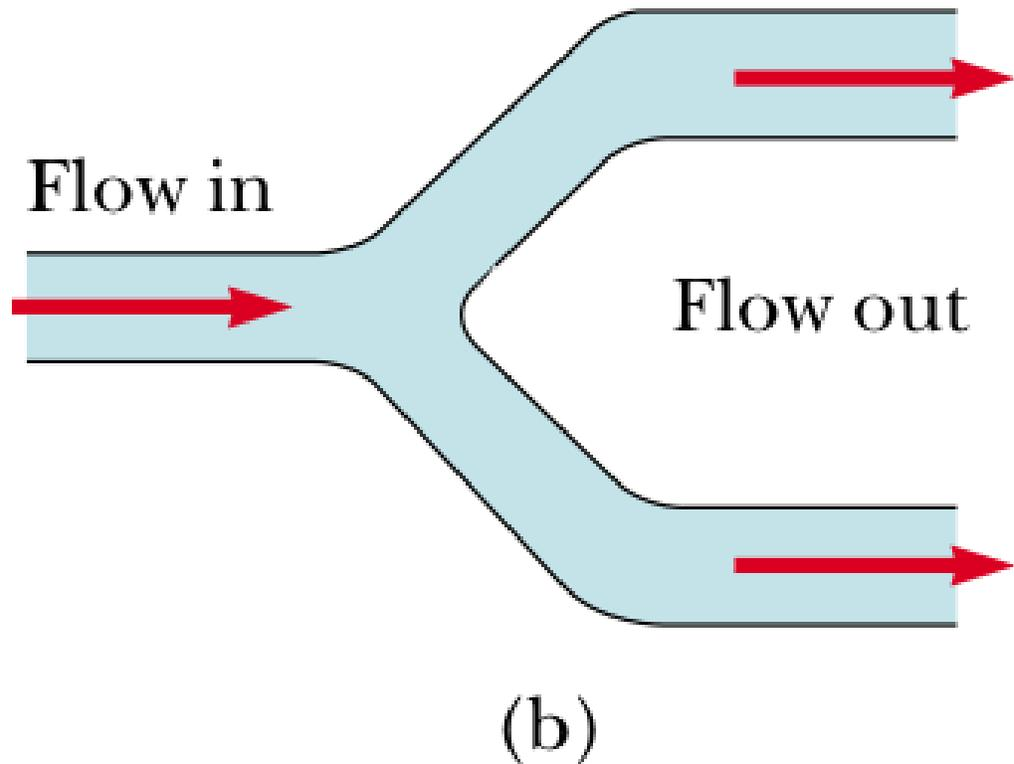
**Fig. 3:** (a) Regla de unión de Kirchhoff. La conservación de la carga requiere que todas las cargas que ingresen a una unión deben salir de esa unión. Por lo tanto,  $i_1 = i_2 + i_3$ . (b) Un análogo mecánico de la regla de unión: la cantidad de agua que fluye de las ramas de la derecha debe ser igual a la cantidad que fluye hacia la rama única de la izquierda.
