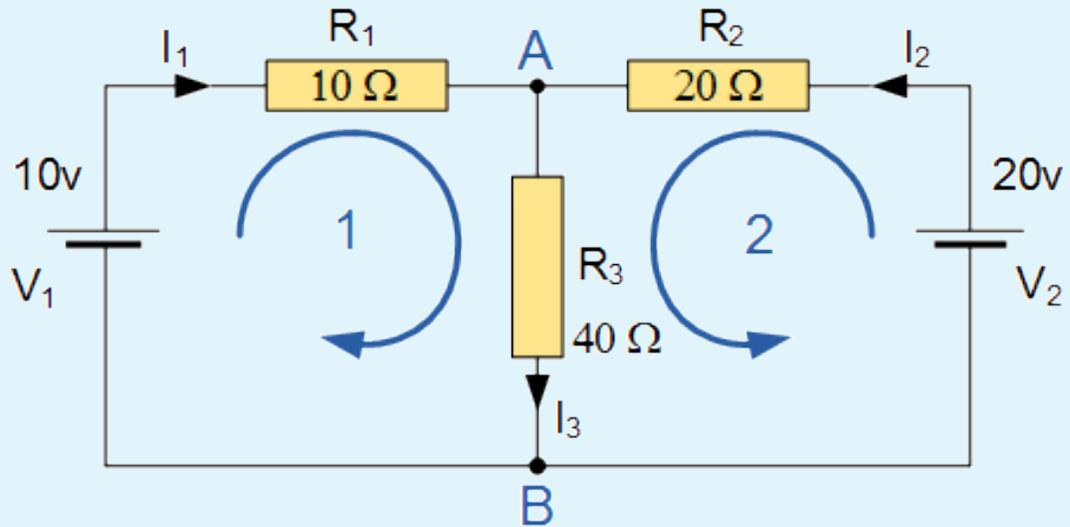
En este caso se pide el valor de la corriente que fluye en la resistencia de  $40\ \Omega$ ,  $R_3$ .
